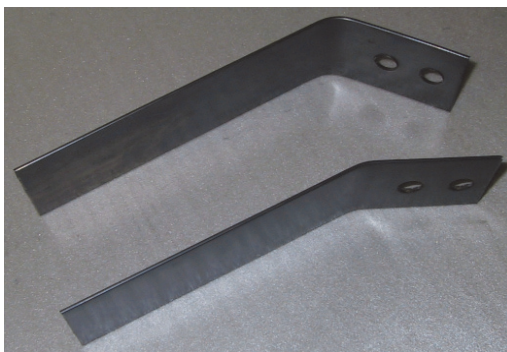
Omrøvevinge, kort og lang model., samt kæde for tilkobling af omrører
