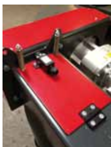
Fjederbelastet låg med kontakt, som stopper sneglen hvis brændslet hober sig op i udløbet
